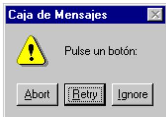
Figura 7.1. Ejemplo de caja *MsgBox*.
